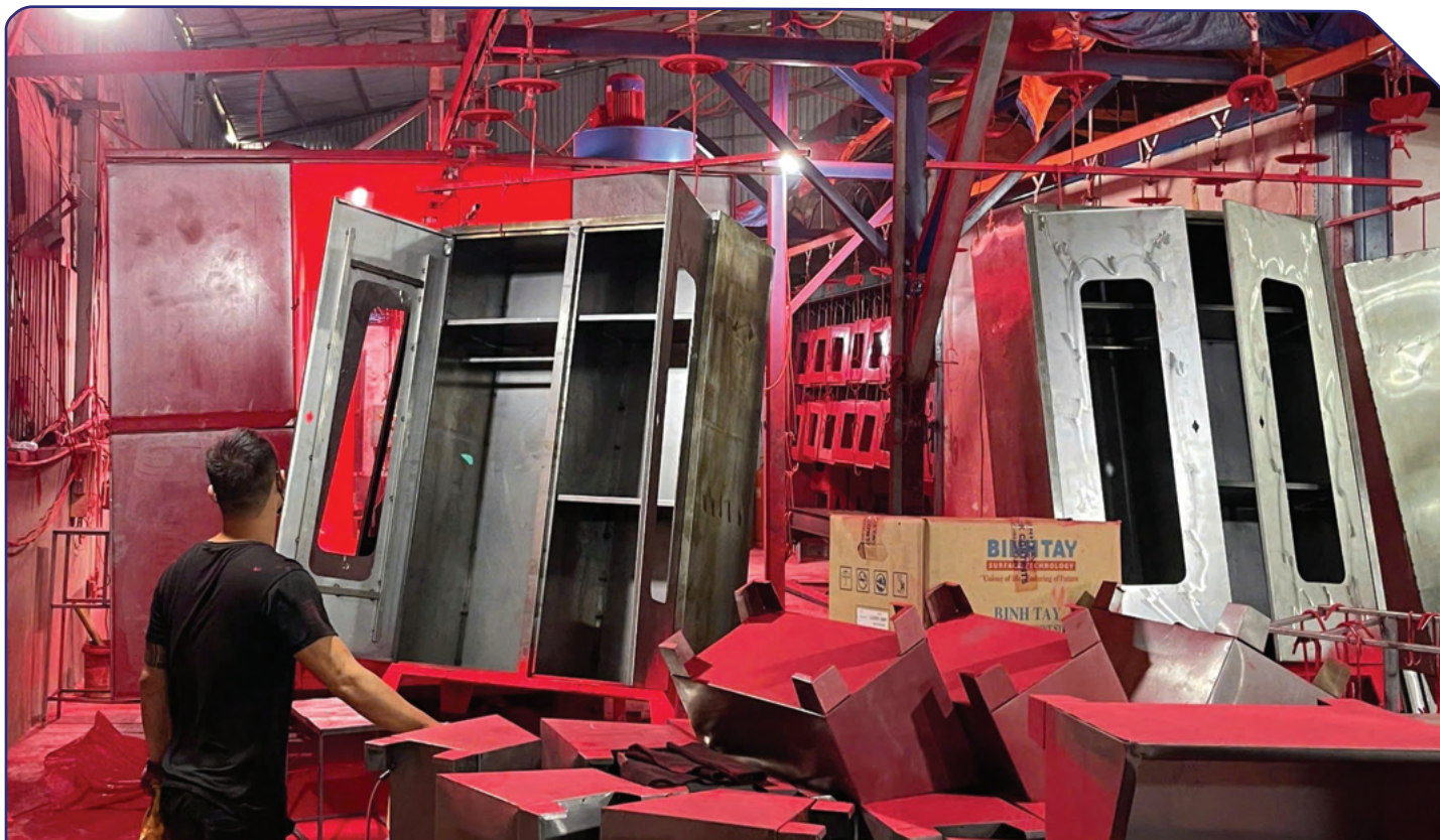
KHU VỰC SƠN TĨNH ĐIỆN
