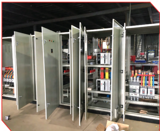
Tủ hạ thế tổng loại ghép khoang Low-voltage cabinet with type of compartment
